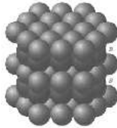
รูปที่ 2.25 ความบกพร่องเนื่องจากอะตอมบริเวณพื้นผิวด้านนอก
