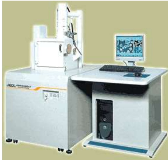
รูปที่ 7.12 กล้องอิเล็กตรอนแบบส่องกราด (Scanning electron microscope, SEM) ที่มา Hiroyuki Fujita, et al. 2001
