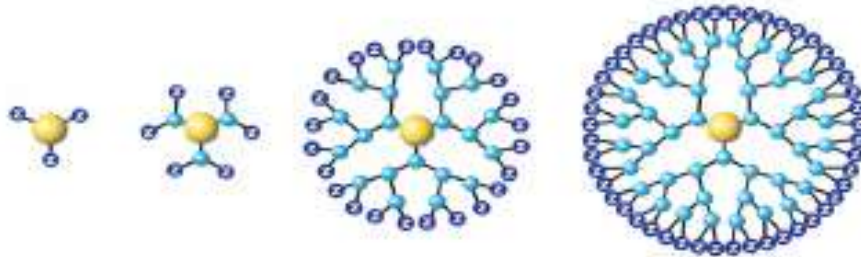
รูปที่ 4.21 ลักษณะโครงสร้างต่อเนื่องของเดนไดรเมอร์ (Dendrimer generation) ที่มา Fisher, J.P., 2007
