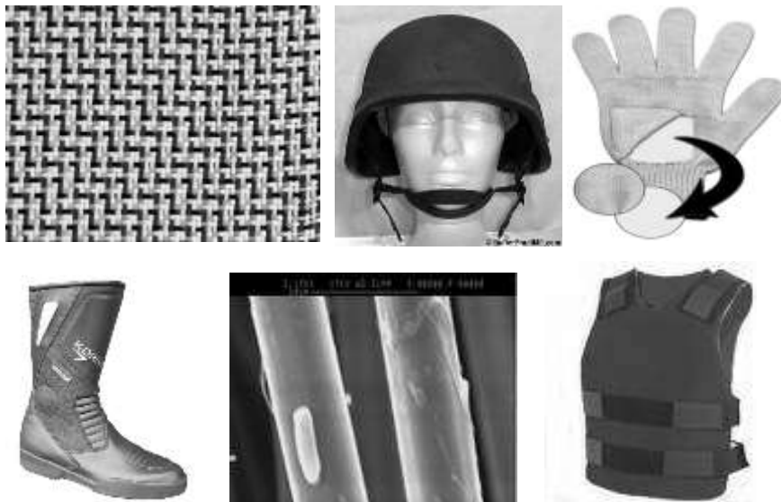
รูปที่ 12.17 การประยุกต์ใช้งานของผลิตภัณฑ์คอมพอสิตเคปล่าเพื่อผลิต หมวก ถุงมือ รองเท้าและเสื้อผ้า ที่มา Saito, S., 1988
