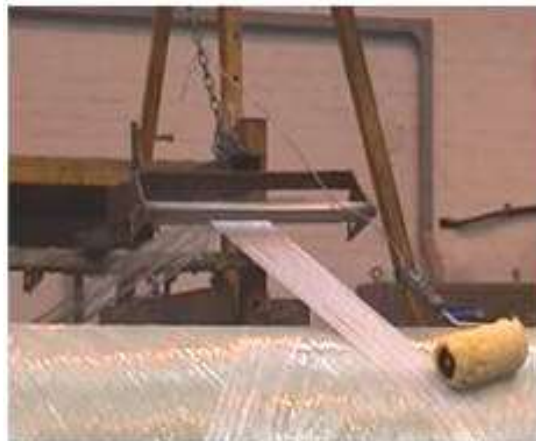
รูปที่ 12.9 การผลิตวัสดุนาโนคอมพอสิตโดยวิธีพัลทรูชัน ที่มา Engineering Materials Handbook, Vol.1, Composites, ASM International, Materials Park, OH, 1987
